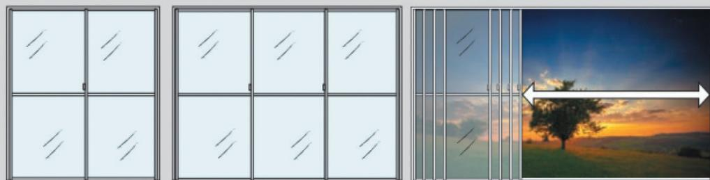
H2T Horizontale à 2 panneaux      H3T Horizontale à 3 panneaux      H4T Horizontale à 4 panneaux
